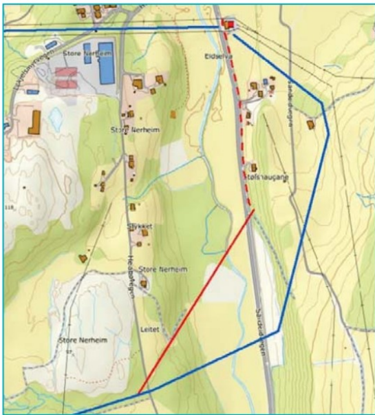
Kart 5: Alternativ 1.1 ut fra Ølen transformatorstasjon. Heltrukken strek er luftledning og stiplede strek er jordkabel. De blå strekene er de konsesjonssøkte alternativene.
