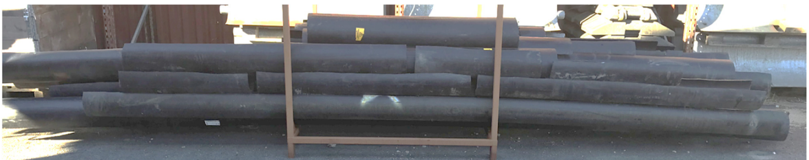
Figur 32. Bilde av halve PE-rør
