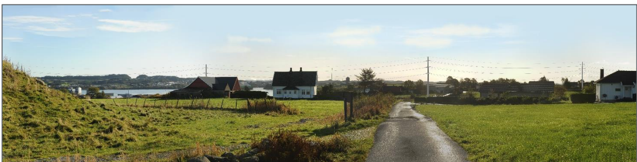
Figur 1-8: Visualisering av ny trasé (alternativ 1d) med vertikalopphengmaster forbi Rehaugane. Kabling av lavspennetnettet er også vist i visualiseringen.
